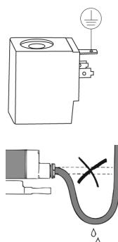
с соответствующей клеммой. Катушка имеет три вывода. Средний вывод должен использоваться для заземления. Для катушки с выводным кабелем это провод желто-зеленого цвета. Два других вывода используются для подключения фазы и нейтрали источника питания. Прежде чем включить соленоидный клапан в работу, рекомендуется проверить его, подав на него электропитание. Должен раздаться щелчок. Все электрические подключения следует выполнять при снятом напряжении питания.
